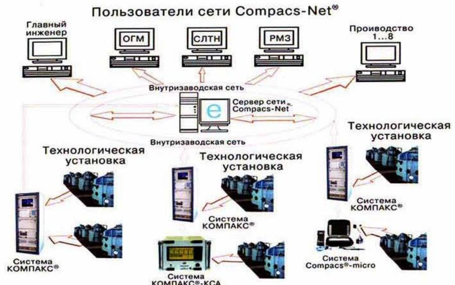
Рис. 2. Структура диагностической сети предприятия на базе Web-технологий и совокупности стационарных и персональных систем мониторинга
