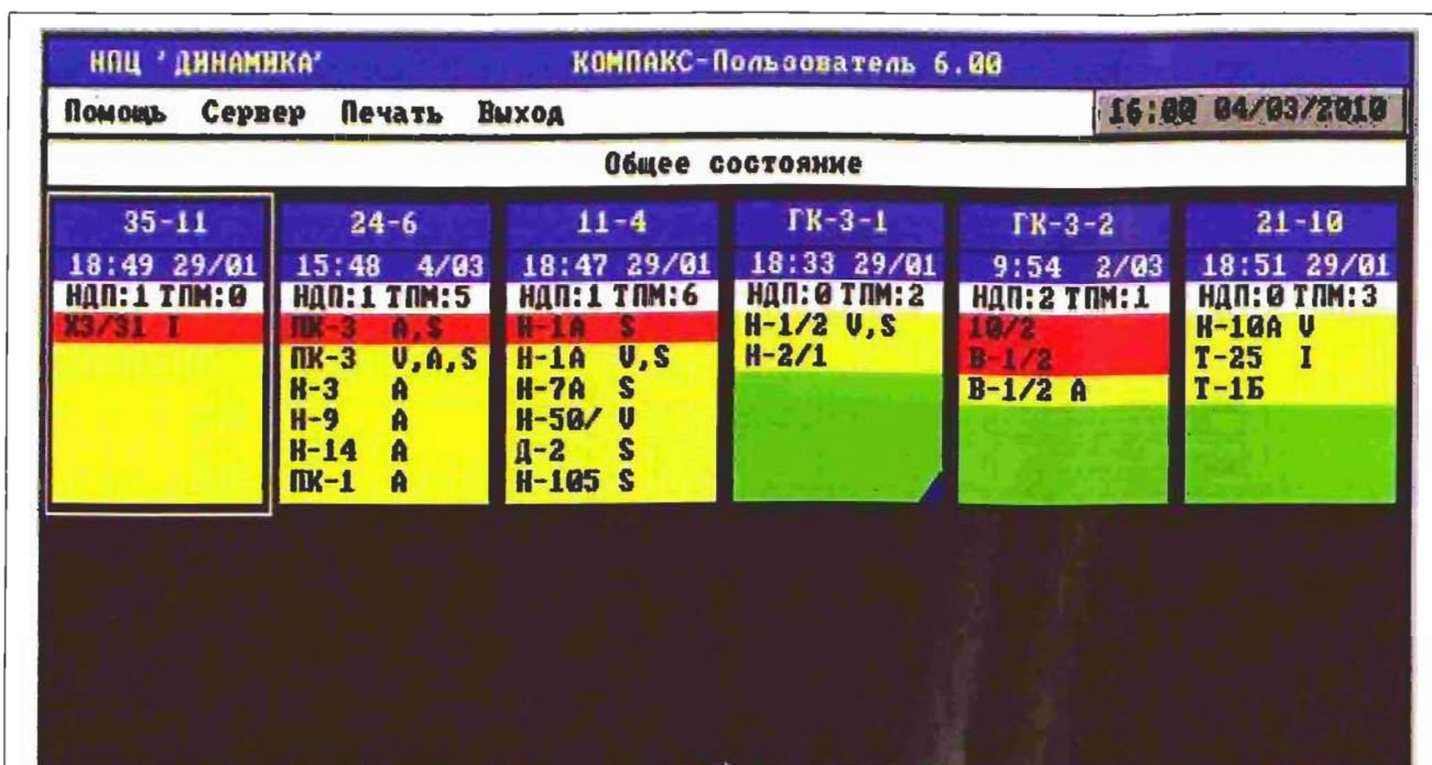
Рис. 2. Экран сервера Диагностической сети Compakc®-Net НПЗ ОАО «АХХК»
