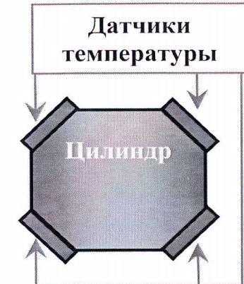
Рис. 16. Измерение температуры клапанов
