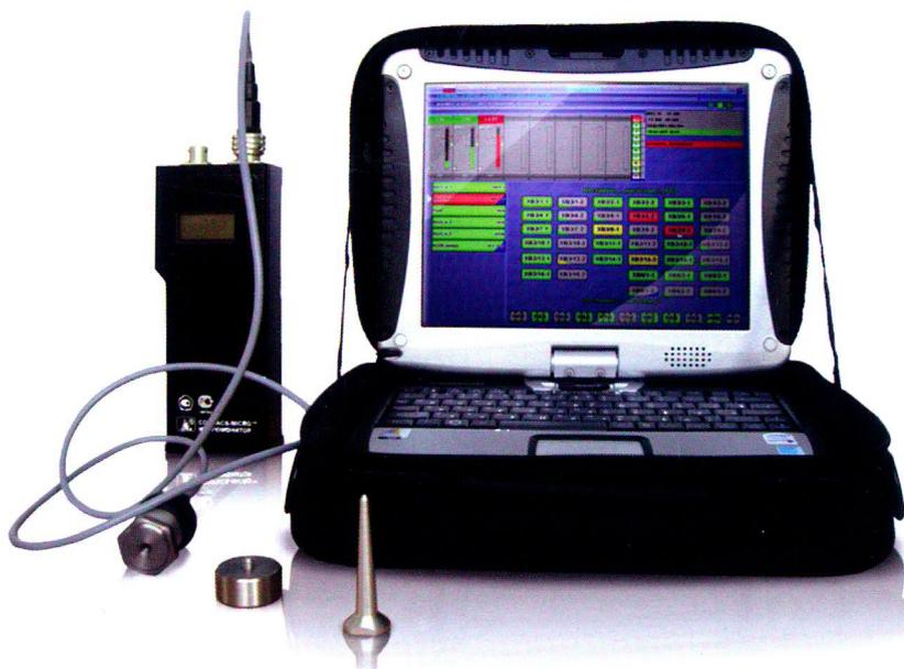
КОМПАКС® и система стендовая для вибродиагностики подшипников качения КОМПАКС®- РПП. Дипломантами конкурса «100 лучших товаров России» стали такие разработки НПЦ «Динамика» как система вибродиагностическая переносная Compass®-micro, система диагностики электродвигателей КОМПАКС®-РПЭ, система стендовая для диагностики и динамической балансировки роторов насосов в собственных подшипниках КОМПАКС®-РПМ, виброкалибратор 8001 и калибратор 8003.
