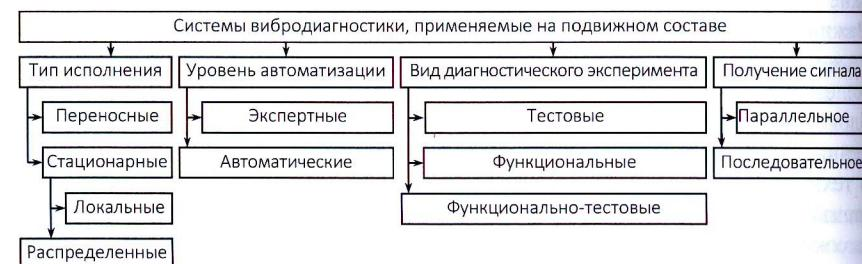
Рис. 1. Схема классификации систем вибродиагностики
