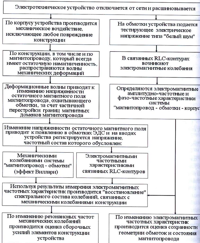
Рис. 2. Основные диагностические процедуры для проведения обследований электротехнических устройств, содержащих обмотки и магнитопровод
