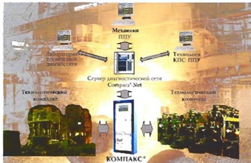
Рис. 1. Структура автоматической системы управления безопасной ресурсосберегающей эксплуатацией оборудования металлургических производств АСУ БЭР КОМПАКС<sup>®</sup>
