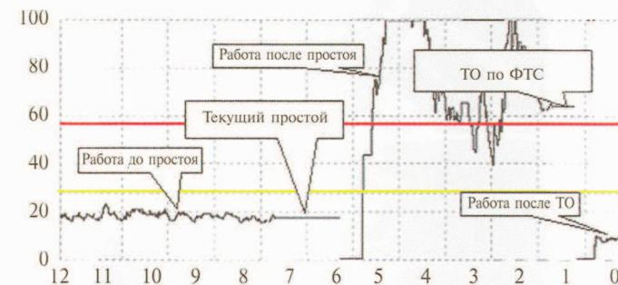
Рис. 4. Тренд вибропараметра, отвечающего за наличие или отсутствие смазки в подшипниковом узле быстроходного вала нижнего редуктора колесопрокатного стана
