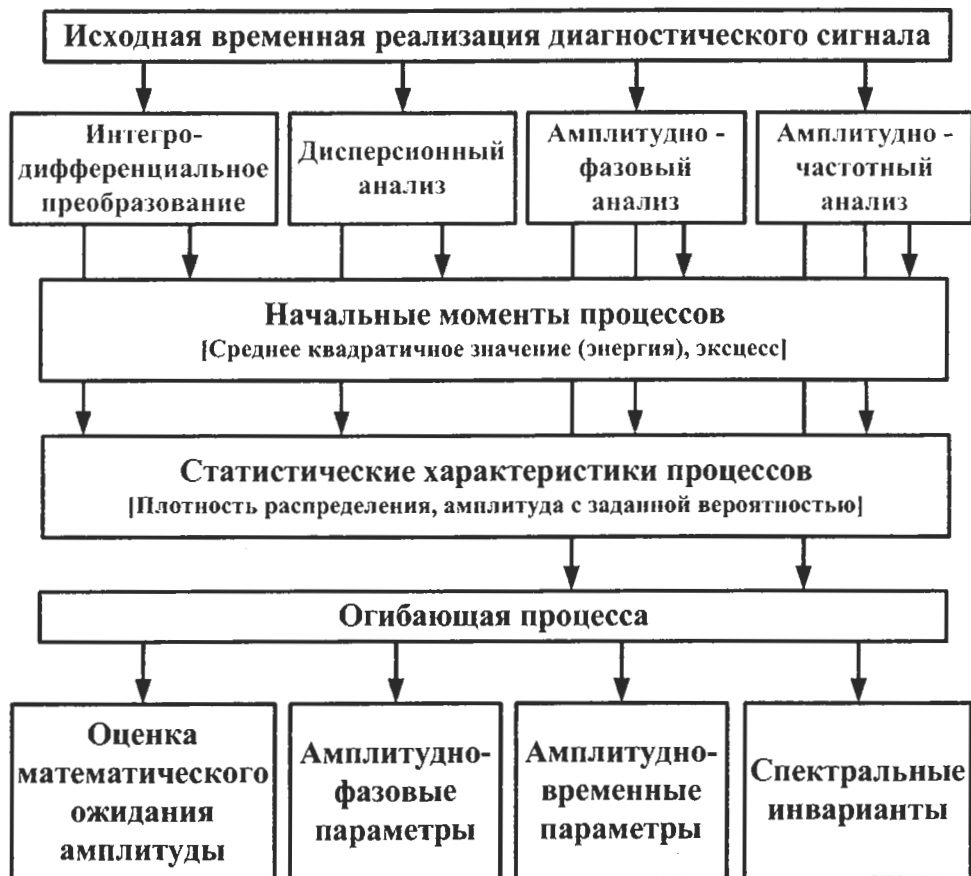
Рис. 1. Методология анализа параметров диагностического сигнала
