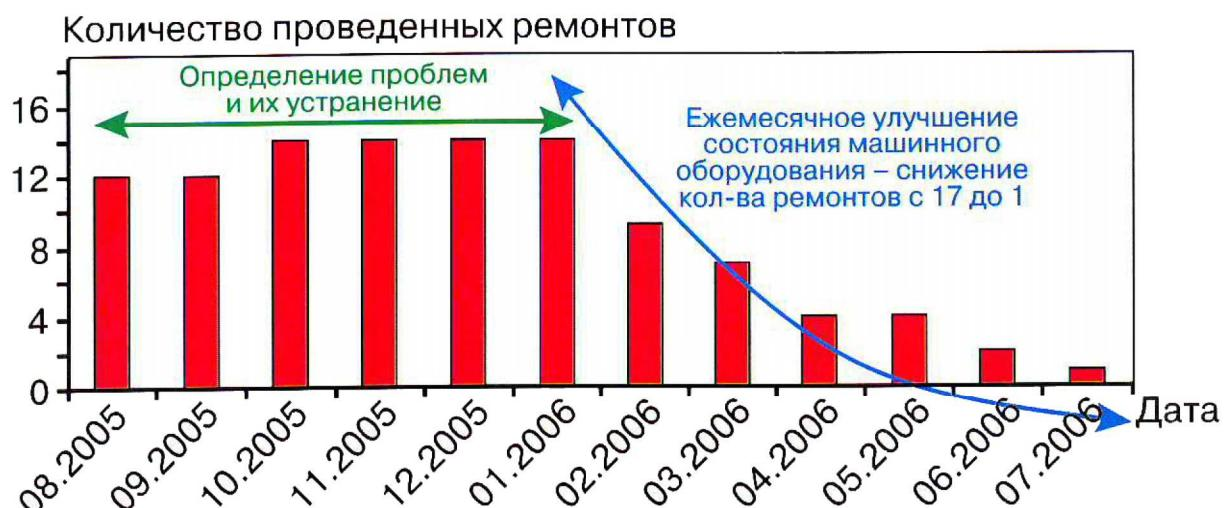
Рис. 9. Полезные ремонты агрегатов установки ККр
