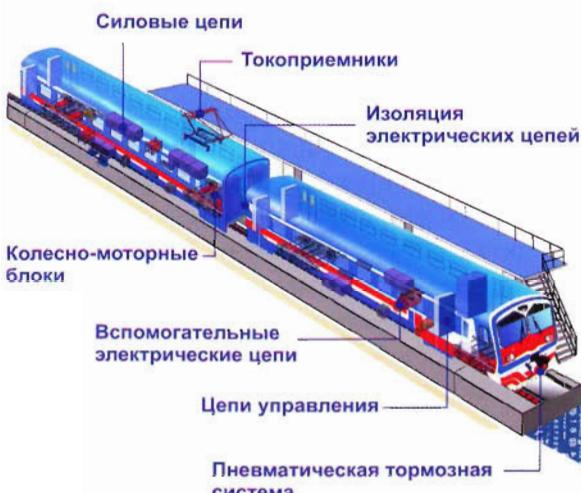
**Система вибродиагностики колесно-моторных блоков в цехе ТР-1**
