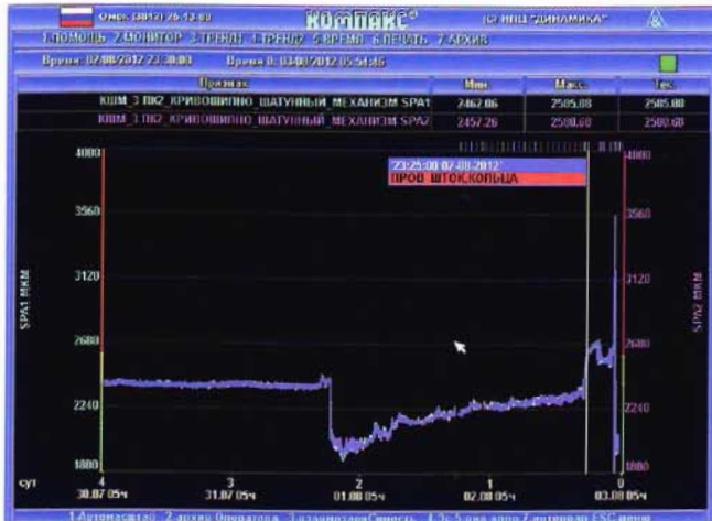
Рис. 2. Тренд относительного положения штока, показывающий процесс изнашивания опорных колец
