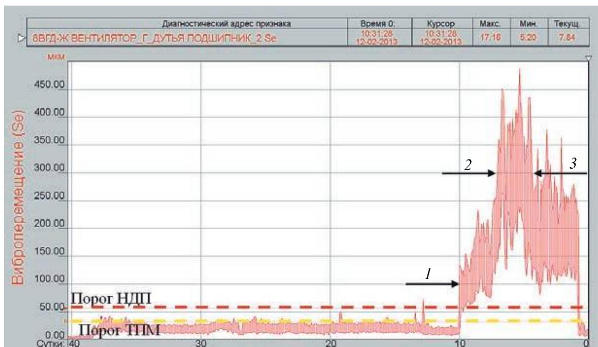
Рис. 6. 40-суточный тренд вибропараметра агрегата 8ВГД-Ж
