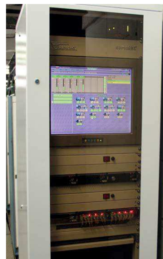
Диагностическая станция системы «КОМПАКС»
