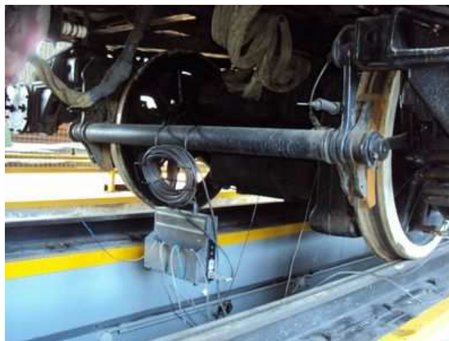
Диагностика КМБ без отцепления от электропоезда
