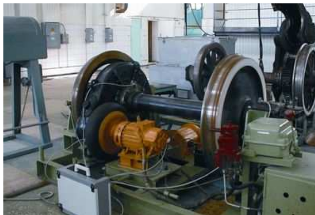
Диагностика КМБ с отцеплением от электропоезда
