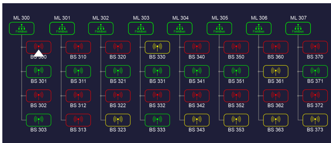
Рисунок 9.4 – Панель объектов диагностики аппаратной платформы «CORNET-WL» с проводными линиями питания и связи
