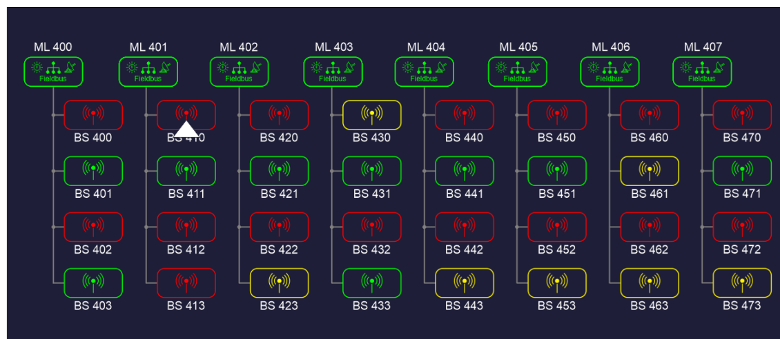
Рисунок 9.5 – Панель объектов диагностики аппаратной платформы «CORNET-WL» с беспроводными линиями связи и питанием от солнечных батарей
